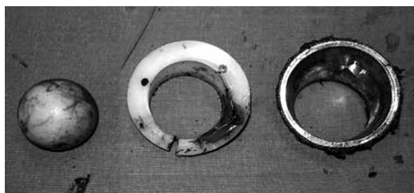
Figura 4: Cerámica y componente acetabular de prótesis rescatada.
